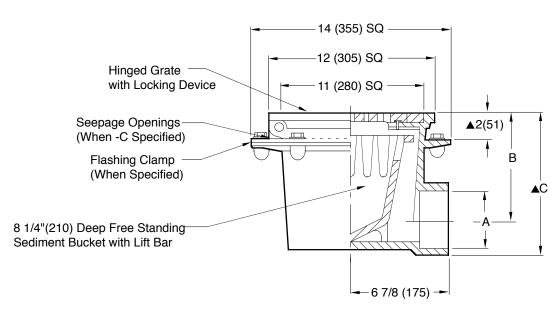
Fig. 2420C . . . LESS FLANGE Fig. 2425C . . . . WITH FLANGE
