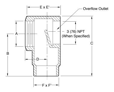
Fig. 1550T . . . . DOWNSPOUT ADAPTOR
