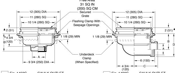
Fig. 1450C . . . . CAULK OUTLET Fig. 1450Y . . . . NO-HUB OUTLET Fig. 1460C . . . . CAULK OUTLET Fig. 1460T . . . . THREADED OUTLET
